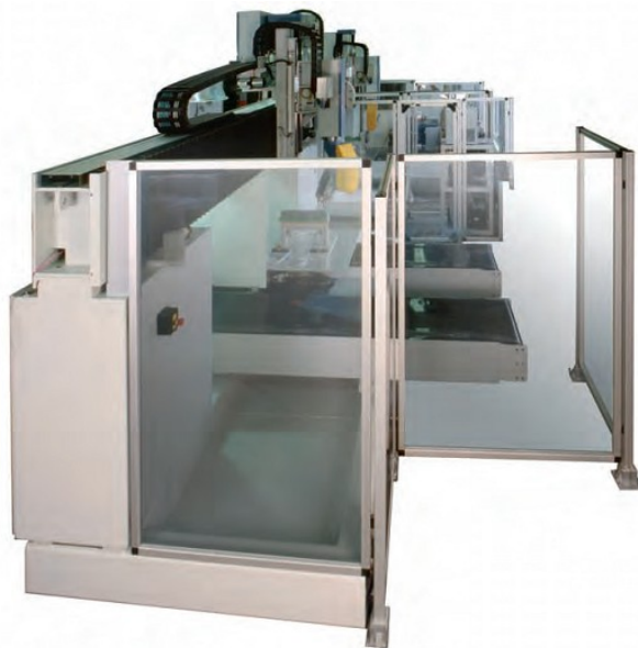
Przykład osłon przezroczystych urządzenia zautomatyzowanego.
